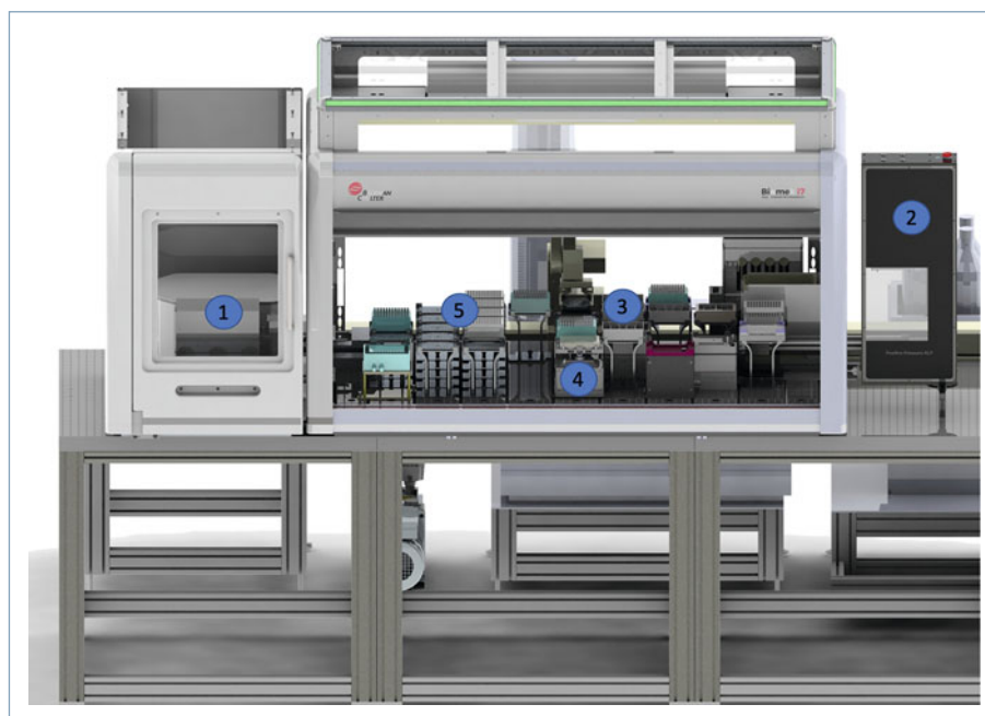
▲ Abb. 2: Liquidhandler Biomek i7 für Flüssigdosier- und Transportprozesse (1), Positive Pressure Extractor für automatisierte Festphasenextraktion (2), Self-Refilling-Reservoir für die Lösungsmittel-/Reagenzienzufuhr (3), 3D-Tilting-ALP für Mischprozesse (4), Deckpositionen für Proben und Labware (5).
