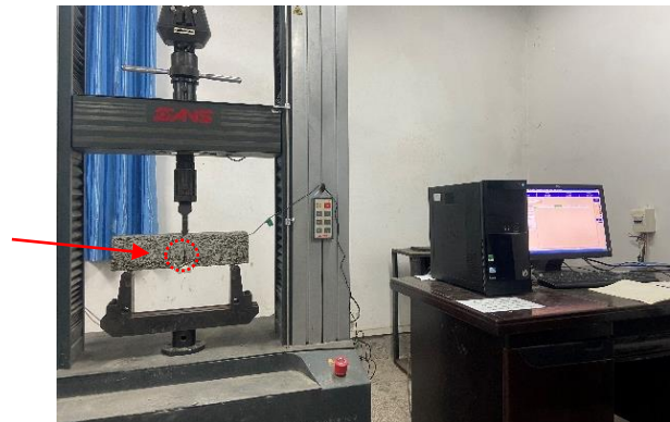
(d) Fracture toughness test setup
