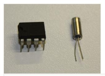
Figure 6. DS1307 RTC and 32.768 kHz crystal.
