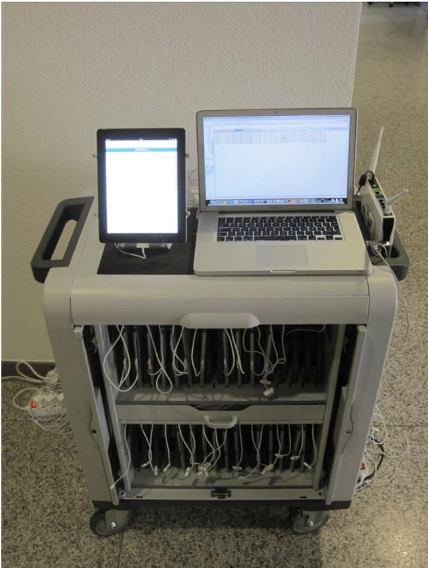
**Abbildung 1:** Tablet-Wagen mit 24 Tablets und Steuerungs-PC (Laptop), WLAN-Komponenten:
