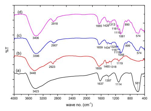
**Figure 2.** FTIR spectra of: (a)  $Fe_3O_4$ ; (b) poly(acrylamide); (c) poly(acrylamide)-g-Cell@ $Fe_3O_4$  (PAC@ $Fe_3O_4$ ); and (d) PAC@ $Fe_3O_4$ -Pb.
