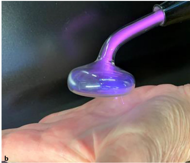
Abb. 12 ◀ Hochfrequenzapparat („violet wands“), ca. 1920er-Jahre: a Objektzusammenhang, b in Aktion. Die unterschiedlichen Färbungen bei der Glimmentladung entstehen durch unterschiedliche Befüllungen der Elektroden mit Gasen (Argon: violett). Die Geräte werden bis heute hergestellt und sind einfach erhältlich. Seit den 1990er-Jahren werden diese auch zur erotischen Stimulation verwandt. (Repro T Stevens, W. P. Didusch Center for Urologic History, Linthicum, mit freundl. Genehmigung)
