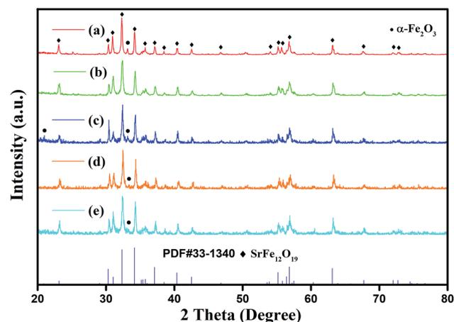
Fig. 2 XRD patterns of specimens with different initial concentration of hydroxyl ions: (a) 2.34 mol L<sup>-1</sup> (b) 2.68 mol L<sup>-1</sup> (c) 3.06 mol L<sup>-1</sup> (d) 3.40 mol L<sup>-1</sup> (e) 3.74 mol L<sup>-1</sup>.
