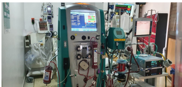
Figura 2 Circuito ECMO VV y circuito CytoSorb. Integración del circuito del ECMO (centrífuga y oxigenador) (derecha) de manera secuencial al filtro de Cytosorb (izquierda) y al filtro de la hemodiafiltración (centro).
