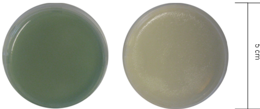
Abbildung 5: Plasmaquelle B, Argon-Plasma, Behandlungszeit 6 min mit Pseudomonas aeruginosa SG81 (links, dichtes Bakterienwachstum) und Staphylococcus epidermidis RP62A (rechts, dichtes Bakterienwachstum)
