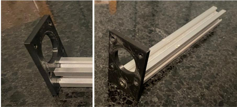
**Fig. 20.** Installing z-axis motor mount.
