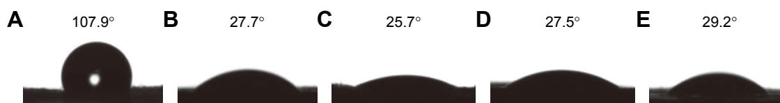
Figure 4 Water contact angle of (A) PCL, (B) PCL/DA, (C) PCL/NS0.5, (D) PCL/NS1.0 and (E) PCL/NS2.0 (n=3).
