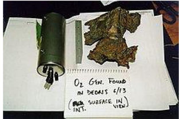
Figure 10. Bougie d'O<sub>2</sub> chimique défectueuse du vol ValueJet 592 (source : Wikipedia).
