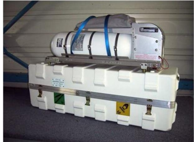
Figure 4. Conditionnement cylindre  $O_2$  aviation pour fixation au sol (source Issoire Aviation : <https://www.issoire-aviation.fr/kit-oxygene-en.php>).
