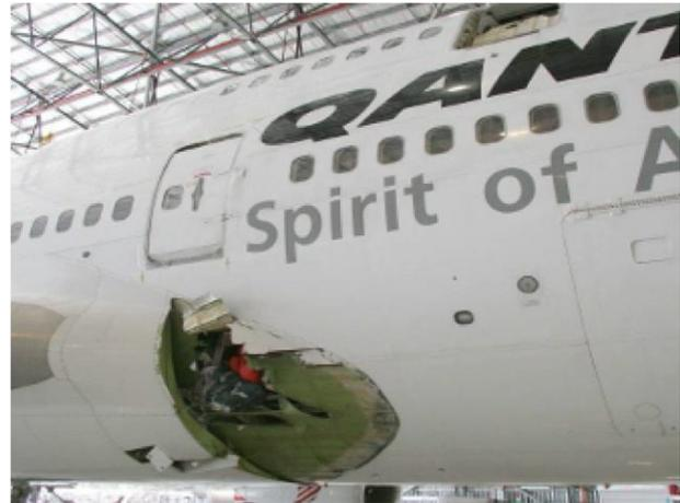
Figure 11. Dégâts sur le vol QF30. Perte de fuselage du Boeing 747 (source [aviation-accidents.net](https://www.aviation-accidents.net/qantas-boeing-b747-438-vh-ojk-flight-qf30/) : <https://www.aviation-accidents.net/qantas-boeing-b747-438-vh-ojk-flight-qf30/>).
