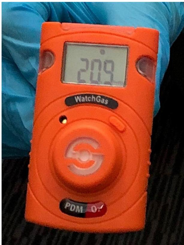
Figure 13. Détecteur de dépassement du taux d'oxygène dans la cabine (source International SOS).
