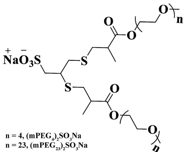
Fig. 1 Chemical structure of  $(\text{mPEG}_4)_2\text{SO}_3\text{Na}$  and  $(\text{mPEG}_{23})_2\text{SO}_3\text{Na}$ .
