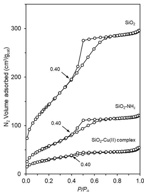
**Figure 4.**  $N_2$  adsorption–desorption isotherms of  $SiO_2$ ,  $SiO_2-NH_2$ , and  $SiO_2-Cu(II)$  complexes.
