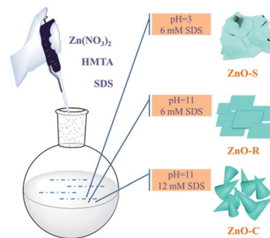
Fig. 1 Preparation of the ZnO/Zn(OH) 2 macrostructures.
