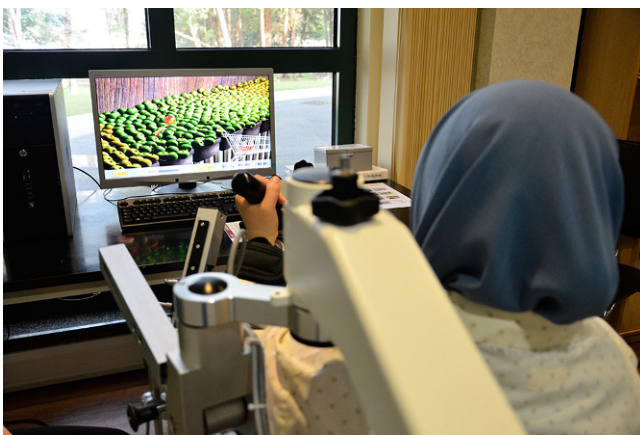
Abb. 2 ▲ Exoskelett (ArmeoSpring®), das die Unterarme und Handmuskulatur trainiert – Patientin muss den Apfel in den Einkaufswagen legen
