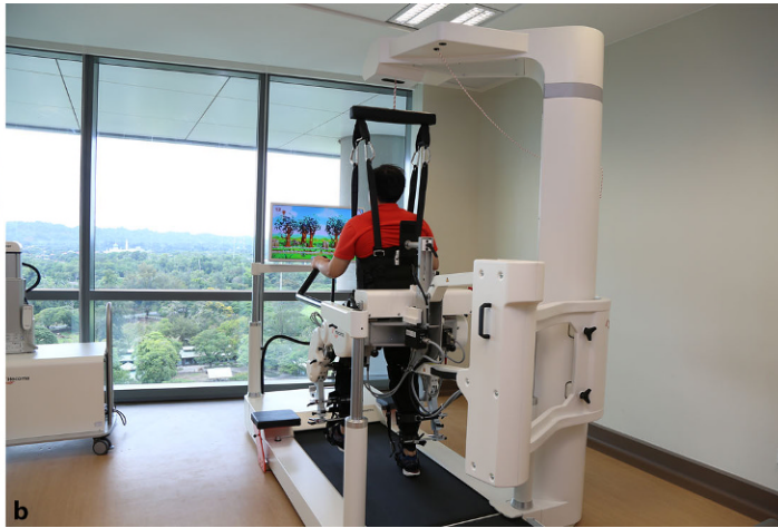
Abb. 1 ◀ Rehasentrum der Klinik in Brunei Darussalam. a Exoskelett (Lokomat®), b stand- und gangfähige, bettlägerige Patienten werden aufrecht gehend rehabilitiert, über Sensoren und Bildschirm gibt es ein Biofeedback
