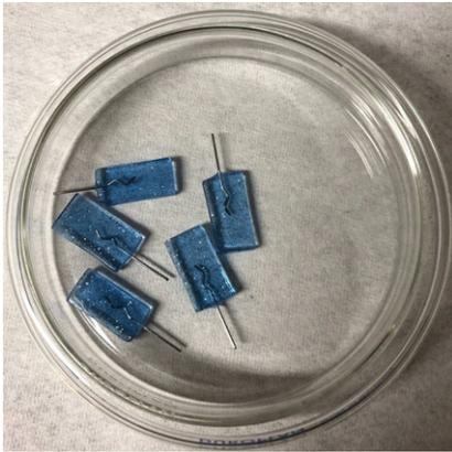
**Abb. 1** ▲ 5 Prüfkörper aus kieferorthopädischem Kunststoff und Stahldraht mit einer Oberfläche von jeweils 5,65 cm<sup>2</sup> in einer Petrischale, die mit 50 ml Korrosionslösung gefüllt ist
