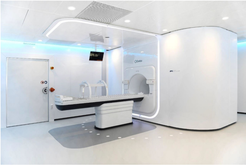
Abb. 2 ▲ Hybrid-Bestrahlungsgerät Unity™ (Elekta Instrument AB Stockholm, Schweden) in Tübingen: Ein 1,5T MRT kombiniert mit einem 7 MV Linearbeschleuniger. (Mit freundlicher Genehmigung von © Universitätsklinikum Tübingen, Britt Moulien. Alle Rechte vorbehalten)
