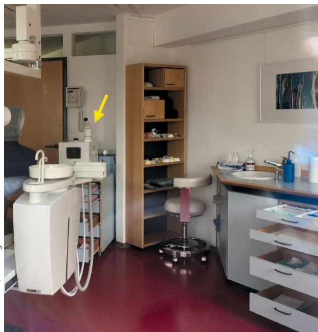
Abbildung 7 Vortex Verneblungsgerät Clean-Cube Classic im Einsatz (durch eine Scheibe fotografiert). Beachtenswert sind die geöffneten Behandlungsschubladen.
