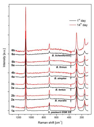
**Figure 8.** RAMAN spectra CaCO<sub>3</sub> precipitates (a—1st day; b—14th day; 1—*S. pasteurii* DSM 33; 2—*B. muralis*; 3—*B. lentus*; 4—*B. simplex*; 5—*B. firmus*; 6—*B. licheniformis*).
