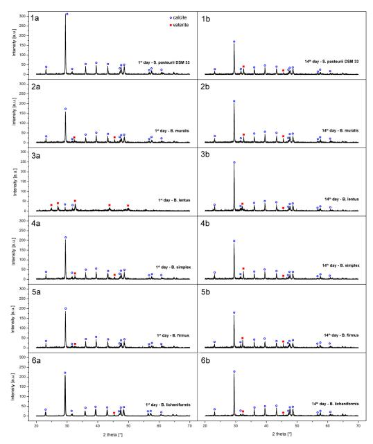
**Figure 7.** XRD spectra of CaCO<sub>3</sub> precipitates (a—1st day; b—14th day; 1—*S. pasteurii* DSM 33; 2—*B. muralis*; 3—*B. lentus*; 4—*B. simplex*; 5—*B. firmus*; 6—*B. licheniformis*).
