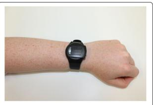
Fig. 2 GeneActiv triaxial accelerometer
