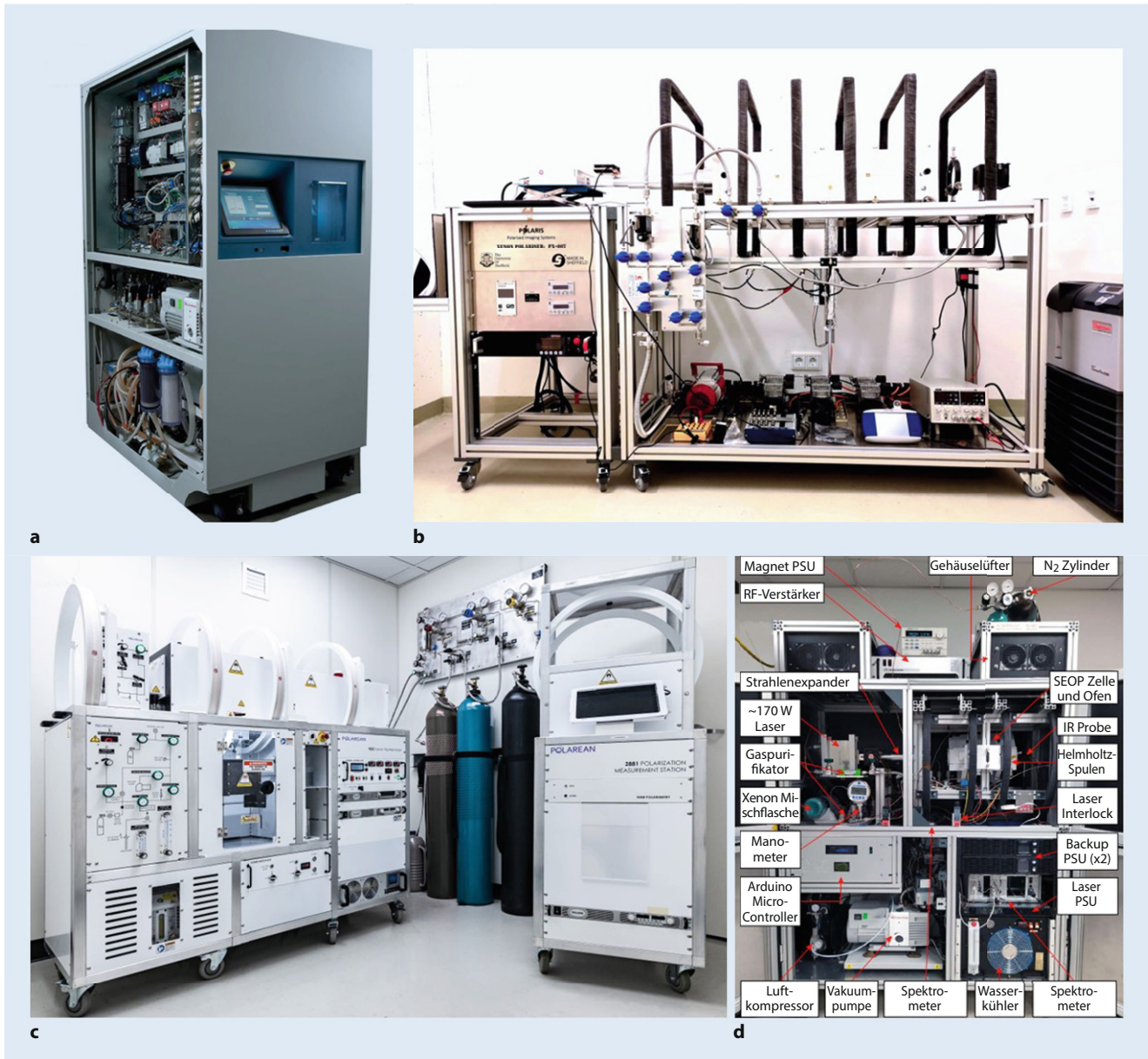
Abb. 2 ▲ Fotos verschiedener aktueller Xenon-Polarisatoren. a XeBox E-10, XeMed, USA ([24], mit freundlicher Genehmigung von John Wiley and Sons). b POLARIS, UK, im Universitätsklinikum Schleswig-Holstein (UKSH) Kiel. c Polarisor 9820, Polarion, USA (Bild von Prof. Driehuys). d XeUS, Gen 2, Cyprus ([22], mit freundlicher Genehmigung von Elsevier)
