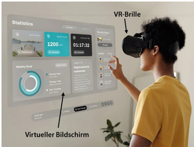
Abb. 1 ▲ Exemplarisches Set-up des NeuroXR-Systems. Der Patient trägt eine VR-Brille, durch die Therapieanweisungen, spielerische Übungen und weitere Inhalte in einer immersiven virtuellen Umgebung dargestellt werden. Die Interaktion mit der virtuellen Welt erfolgt intuitiv über Handgesten und durch das gezielte Drücken von Knöpfen mit den Fingern
