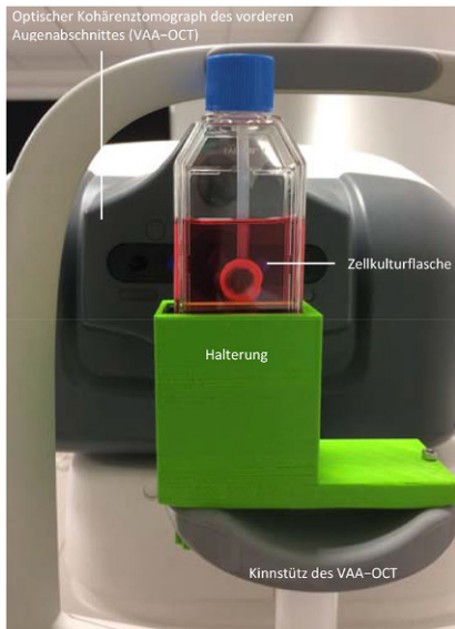
Abb. 1 ▲ Präoperative Messungen der Spenderhornhäute. Präoperative Messungen wurden steril durch die Zellkulturflasche mit dem optischen Kohärenztomographen des vorderen Augenabschnittes (VAA-OCT) durchgeführt. Die Kulturflasche wurde in einer Halterung auf dem Kinnträger des VAA-OCT positioniert, die zuvor mit einem 3-D-Drucker hergestellt wurde
