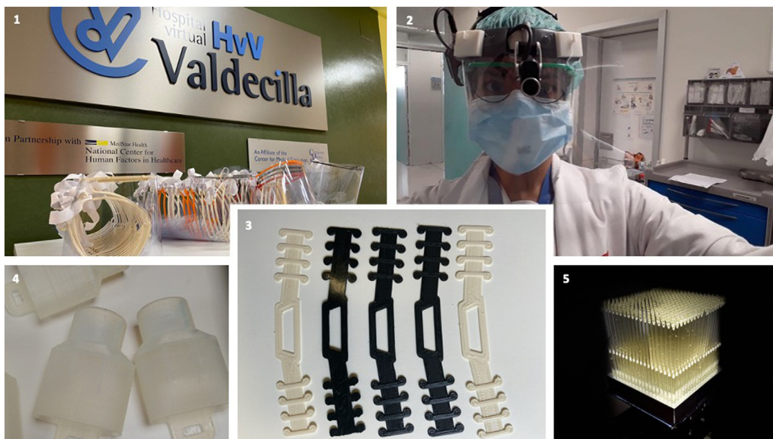
Figura 1 Pantallas faciales (1), accesorios para fotóforos (2), horquillas salvaorejas para mascarillas (3), conectores para ventilación no invasiva (4) e hisopos naso y orofaríngeos (5) fabricado mediante impresión 3D en el Hospital Marqués de Valdecilla.
