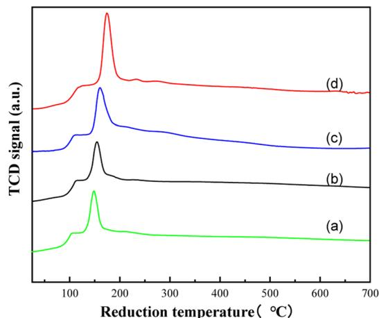
Fig. 5  $\text{H}_2$ -TPR plots of the Ru–Sn/ $\text{Al}_2\text{O}_3$  catalyst with different ratios: (a) Ru : Sn = 2 : 1; (b) Ru : Sn = 1 : 1; (c) Ru : Sn = 1 : 2; (d) Ru : Sn = 1 : 3.
