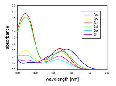
**Figure 3.** UV–Vis absorption spectra of the Schiff bases **3a–f** in ethanol  $(1.25 \times 10^{-5} \text{ M})$ .
