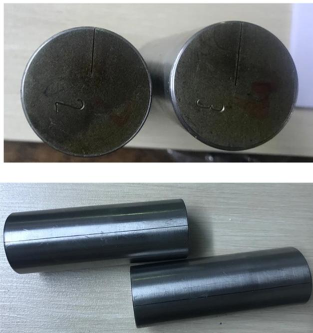
Figure 1. Metal core plug.
