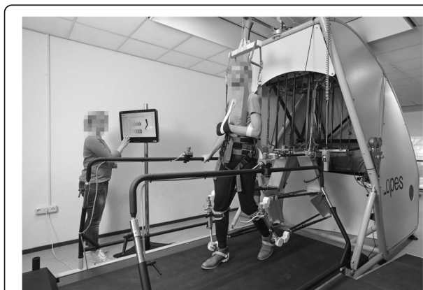
Fig. 2 Robotic gait trainer LOPES II
