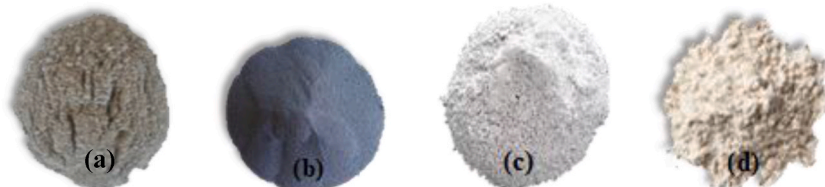
Fig. 2. (a) FA, (b) SF, (c) GGBS and (d) MK
