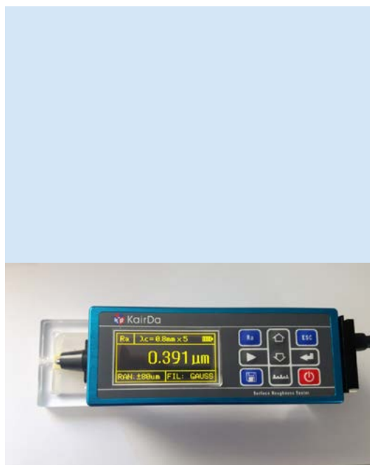
Slika 1. Mjerenje hrapavosti površine profilometrom Figure 1 Surface roughness measurement with profilometer.
