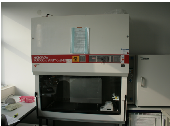
Abbildung 1: In der Sicherheitswerkbank aufgestellte Box zur Ermittlung der mikrobiellen Emission von je einem innerhalb der Box in Betrieb befindlichem Laptop
