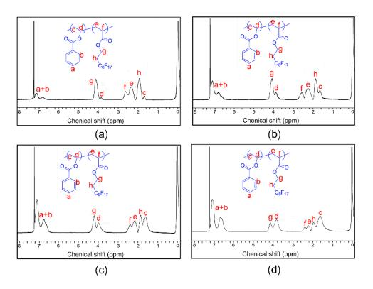
**Figure 3.** <sup>1</sup>H-NMR spectrums for P(HFDA-*co*-VBe) co-polymers. (a) P(HFDA<sub>0.87</sub>-*co*-VBe<sub>0.13</sub>); (b) P(HFDA<sub>0.67</sub>-*co*-VBe<sub>0.33</sub>); (c) P(HFDA<sub>0.50</sub>-*co*-VBe<sub>0.50</sub>); (d) P(HFDA<sub>0.29</sub>-*co*-VBe<sub>0.71</sub>).
