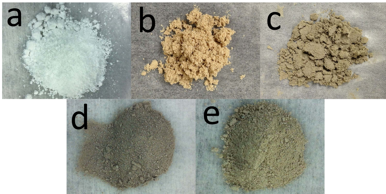
Figure 1. Photographs of pristine TiO 2 (a) and doped TiO 2 samples, (b) TiO 2 -1, (c) TiO 2 -2, (d) TiO 2 -3 and (e) TiO 2 -4.
