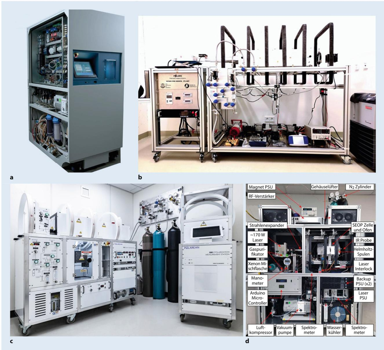
**Abb. 2** ▲ Fotos verschiedener aktueller Xenon-Polarisatoren. **a** XeBox E-10, XeMed, USA ([24], mit freundlicher Genehmigung von John Wiley and Sons). **b** POLARIS, UK, im Universitätsklinikum Schleswig-Holstein (UKSH) Kiel. **c** Polarisor 9820, Polarisan, USA (Bild von Prof. Driehuys). **d** XeUS, Gen 2, Cyprus ([22], mit freundlicher Genehmigung von Elsevier)
