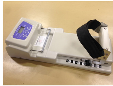
Fig. 1. T.K.K.3362 toe-grip dynamometer
