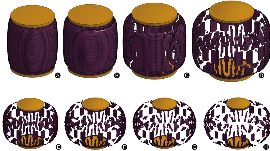
Fig. 3. Formation of natural fragments. (A) t = 20 \mu\text{s} ; (B) t = 25 \mu\text{s} ; (C) t = 35 \mu\text{s} ; (D) t = 50 \mu\text{s} ; (E) t = 60 \mu\text{s} ; (F) t = 70 \mu\text{s} ; (G) t = 80 \mu\text{s} ; (H) t = 90 \mu\text{s} .
