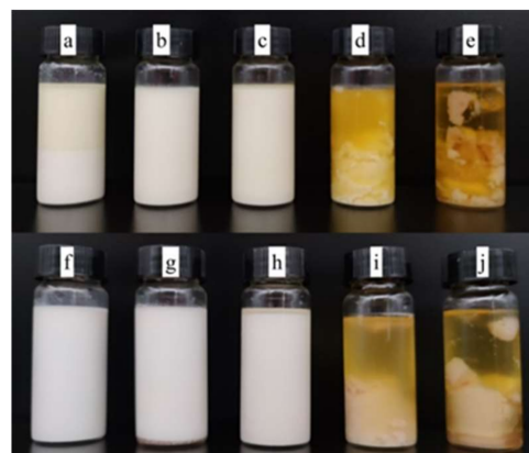
Figure 7. Digital photographs of W/O emulsions including Em 1 (a), Em 2 (b), Em 3 (c), Em 4 (d), Em 5 (e), Em 6 (f), Em 7 (g), Em 8 (h), Em 9 (i), and Em 10 (j), after 30 days of storage at room temperature.
