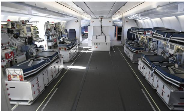
Figure 1. Intérieur d'un Airbus A 330 PHENIX MRTT équipé des modules MoRPHEE (Auteur : Laurent Raynaud).
