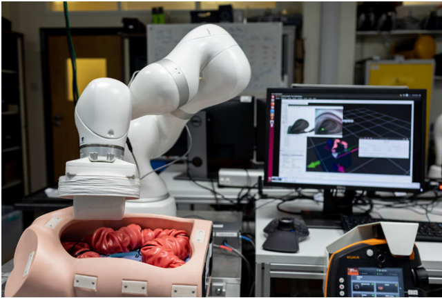
Abb. 3 ◀ Ein flexible Koloskop, das durch einen externen robotisch geführten Magneten durch das Kolon bewegt wird. (Mit freundl. Genehmigung, ©STORM Lab, University of Leeds, Leeds, Vereinigtes Königreich)
