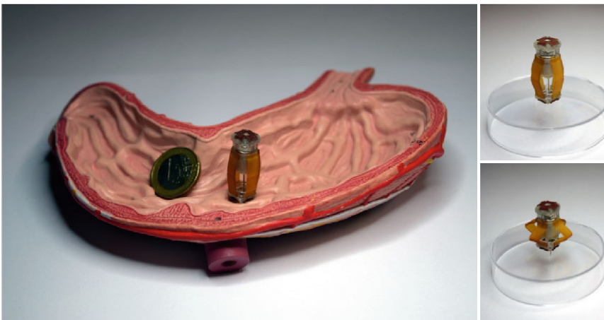
Abb. 4 ▲ Eine weiche Endoskopiekapsel, die Bilder aufnimmt und eine Biopsie im Magen durchführt. (Mit freundl. Genehmigung, ©Max Planck Institute for Intelligent Systems, Tübingen, Deutschland)
