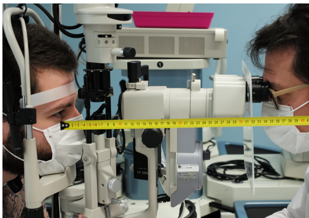
Figure 4. Dispositif de prévention lors de l'examen en lampe à fente. Protection en plexiglas réalisée sur mesure installée au niveau des oculaires. Port de masques de rigueur pour le patient et l'ophtalmologiste, dont les visages sont plus proches que la distance recommandée pour éviter la transmission (35 cm à la place d'un mètre).
