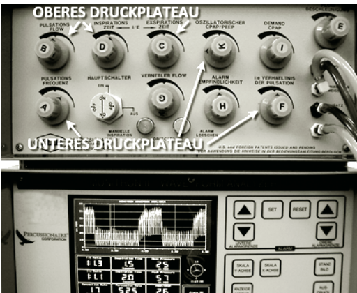
Abb. 51. Hochfrequenzrespirator für die intensivmedizinische Anwendung: VDR-4 (Fa. Percussionaire Corp., Idaho USA). Grundeinstellung: Das obere Druckplateau wird mittels Pulsationsflow, Inspirations- und Expirationszeit erstellt. Das untere Druckplateau mittels oszillatorischem PEEP und Pulsationsfrequenz. Das Monitoring zeigt die zwei pulsierenden Druckplateaus. I:E ist 1:2
