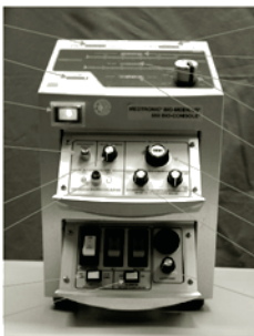
Abb. 61. Darstellung des Schaltpultes für eine extrakorporale Membranoxygenierung. Es besteht die Möglichkeit eines internen oder externen Antriebes (Fa. Medtronic Austria GmbH)
